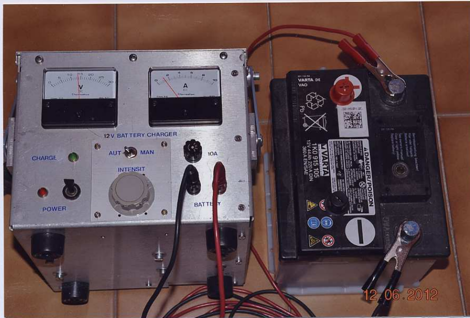
Figuras N°5 y N°6: Cargador de baterías de 44 a 85 Ah automático (LM338). En la foto superior, una vista interior donde tenemos a la izquierda, el compartimento para cables y accesorios, a continuación el transformador T1 que queda en primer término, posteriormente el radiador de U1 y U2, el soporte con la placa de control con U3, U4, Q1, Q2 y RL1. En la vista inferior, el cargador operativo, cargando una batería de 12 V / 44 Ah, en el modo automático el cual, permite una intensidad de carga máxima de 6 A y estado posterior de mantenimiento.
