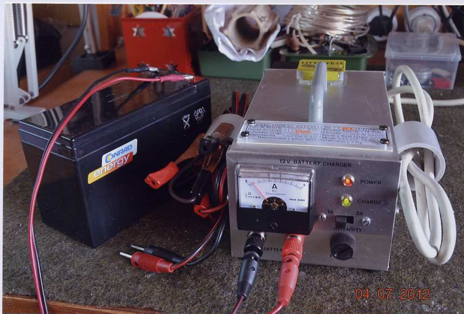
Figuras N°3 y N°4: Cargador de baterías de 7 a 44 Ah automático (LM338). En la foto superior, una vista interior de izquierda a derecha, tenemos en primer lugar la placa de control con U2, Q1 y el relé RL1, a continuación el transformador T1 y finalmente en el exterior, el refrigerador del regulador de tensión U1. En la vista inferior, el cargador ya operativo cargando una pequeña batería de 12 V / 7 Ah, utilizando la escala de 1 Amper para máxima carga, y mantenimiento.
