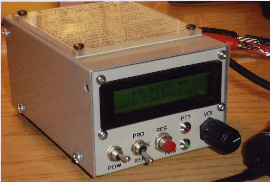
Figuras N° 1 y N° 2: Modem adaptador DV (Voz Digital) EA3-CNO. En la foto superior, una vista interior del modem con la placa base y la placa auxiliar "B" sobrepuesta, a la izquierda el panel frontal con los mandos y el display, a la derecha el panel posterior con los conectores. En la foto inferior, el aspecto exterior del modem, con el display de datos, los mandos, indicadores led y volumen de voz. El conector de micro PTT y altavoz, quedan en el lateral de la caja.
