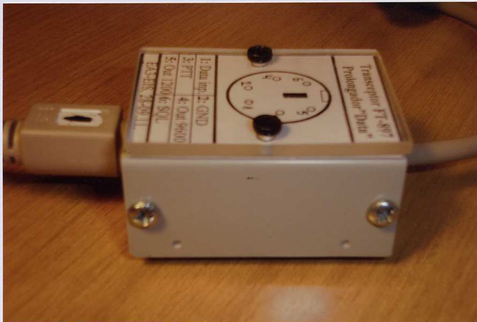
Figuras N°3 y N°4: Modem adaptador DV (Voz Digital EA3-CNO. En la foto superior el modem ya operativo, asociado al transceptor Yaesu FT-897 y sintonizando el repetidor R2 de BCN frecuencia 145,650 MHz. En la foto inferior, el prolongador del conector Data del mismo transceptor el cual, permite la interconexión de manera fácil con el modem adaptador.
