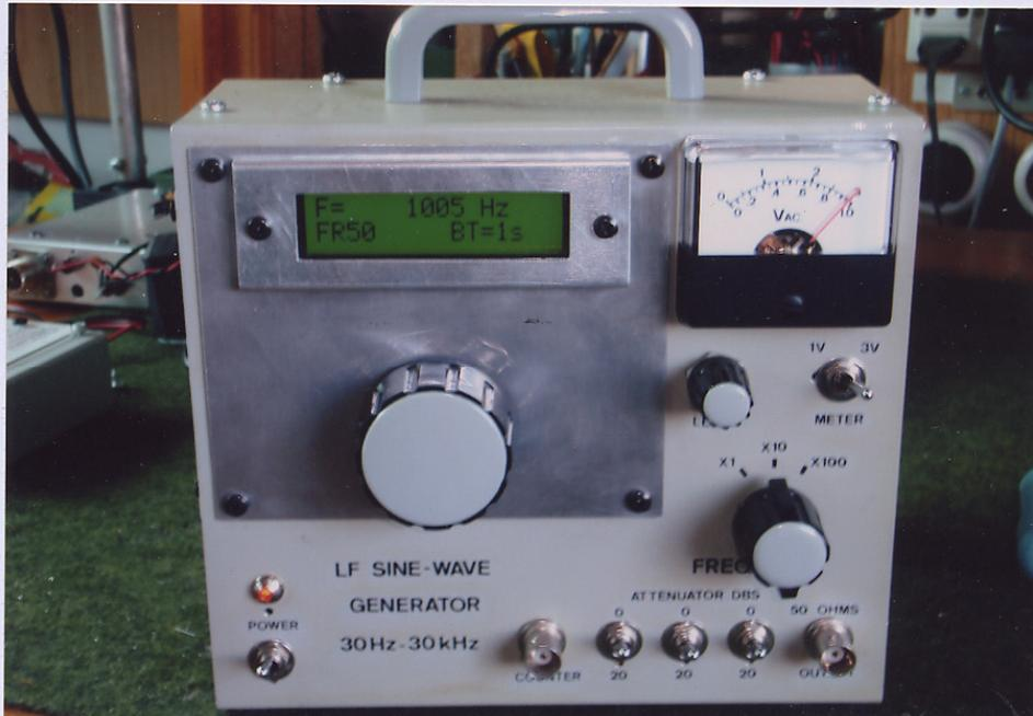
**Figura N°8:** Vista exterior del generador senoidal de BF. Vemos el contador de frecuencia, el instrumento de c/m con sus escalas, los pocos mandos y más abajo, el atenuador por pasos de 20 dB seguido, de la salida BNC de señal a 50 Ohms de impedancia.
