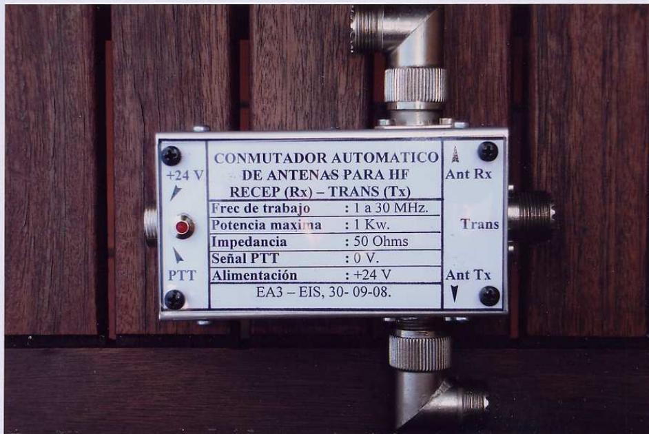
**Figura N°3:** Vista exterior del conmutador automático de antenas Rx-Tx para HF. A la izquierda el conector J1 de control y maniobra RX-Tx, a la derecha los conectores PL: J2, J3 y J4.
