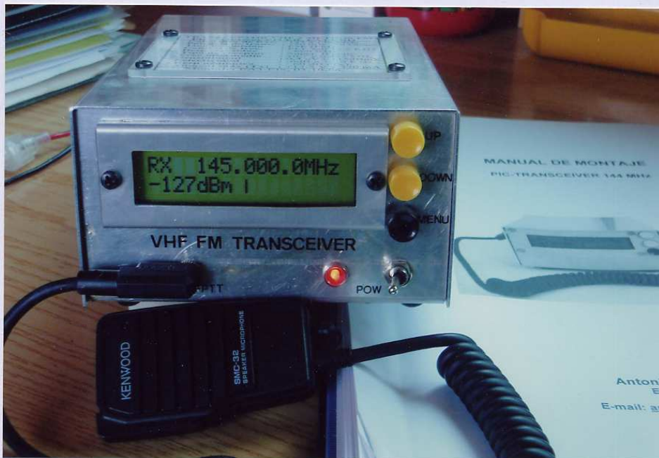
Figura N°2: Vista exterior del Pic-Transceiver 144 MHz. El panel frontal con la pantalla LCD la cual, presenta la frecuencia en MHz y la señal Tx del correspondal en dBm. Los tres pulsadores: Up, Down y Menú como únicos mandos del transceptor. El micro y PTT en primer término.
