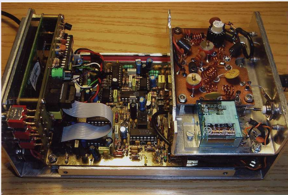
Figura N° 2: Detalles de la modificación del PIC-Transceiver 144 MHz EA3-CNO (15-05-10). Amplificador RF 2 metros FM (5 W): En primer lugar la placa CI mecanizada, provista de isletas circulares practicadas mediante broca de corona de 4 m/m de diámetro, a continuación la misma placa con los componentes ya montados, formando el amplificador de RF de 5 W de potencia útil. En la foto parte inferior, el conjunto amplificador, relé RL1 y conector BNC hembra de Antena, todo montado sobre una "U" de aluminio, que hace las funciones de soporte mecánico y también, de separación electrostática, con respecto a la circuitería del transceptor función Tx.
