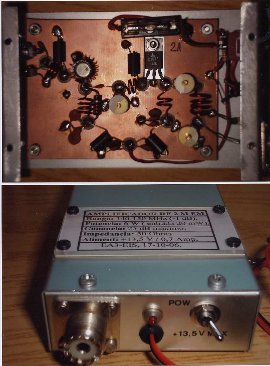
Figura N°2: Amplificador de RF para 2 metros modalidad FM (6 W). En la foto superior, vista interior de dicho amplificador de RF, con la situación de todos los componentes, soldados superficialmente sobre isletas practicadas en la cara de Cu de la placa soporte la cual, queda sujeta a la caja mediante cuatro separadores exagonales M3. En la foto inferior, tenemos el aspecto exterior del amplificador ya terminado; cuyo frontal contiene, el conector PL de salida RF, la entrada de alimentación +13,5 V, controlada por el interruptor y led Power; en la parte posterior no visible, tenemos el conector BNC de entrada RF.
