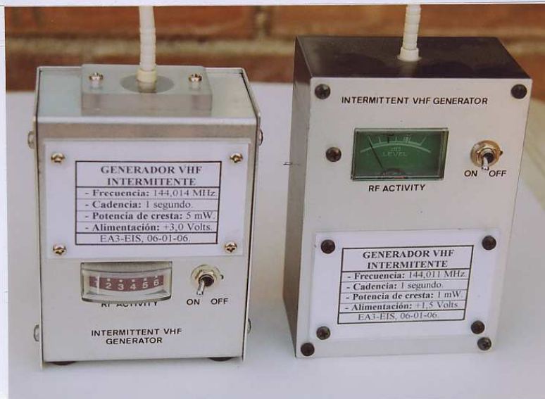
Figura N°3: Vista exterior de los dos Generadores VHF intermitentes, el primero por la izquierda de 5 mW y el segundo de 1 mW. Ambos están dotados de los mismos elementos de control y circuiteria, salvo la alimentación, en el segundo se hace con una sola pila de 1,5 Volts tipo AA. En el primer generador, la caja es totalmente de Al de construcción casera y en el segundo, tanto el panel como la caja de plástico son de recuperación.
