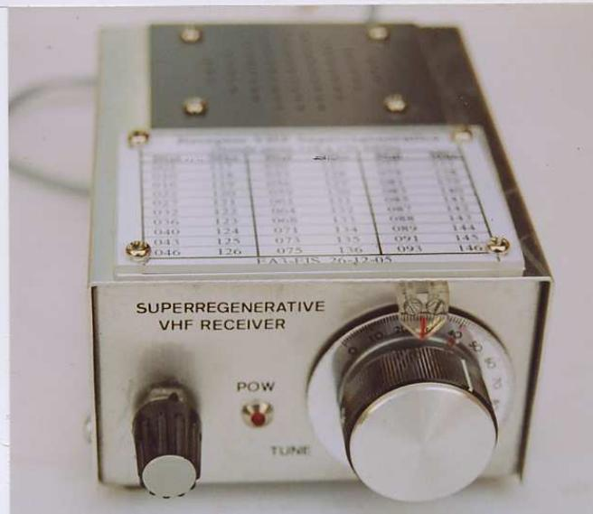
**Figura N°3:** Vista exterior del receptor superregenerativo de VHF. En ella se aprecia la simplicidad operativa al mostrar, los dos únicos mandos que aparecen en el panel frontal, el de sintonía TUNE y el de amplitud AF GAIN con el led rojo de control POWER
