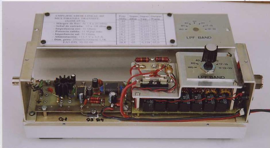
**Figura N° 3:** Amplificador lineal HF multibanda (2 x 2SC1972). Este amplificador de carácter más bien experimental, complementa el Excitador HF multibanda SSB y CW. De derecha a izquierda, el conector de entrada BNC, el amplificador lineal con los transistores de potencia Q2 y Q3 adosados a la base metálica, a continuación los filtros LPF seleccionados por relés y conmutador rotativo de bandas, todo según esquemas: Figuras N° 1 y 2, finalmente el conector PL para la señal de salida.
