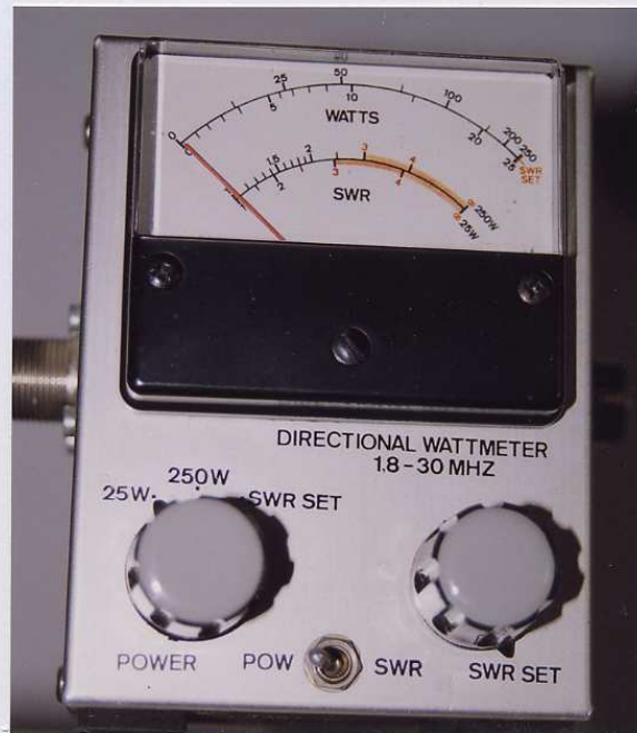
Figura N° 3: Vista exterior del vatímetro direccional HF. Destacan, el instrumento de c/m con sus escalas Watts y SWR, también los dos conectores PL de ANT y TX, mandos: selector de potencia POWER, ajuste SWR SET y conmutador selector POW – SWR.
