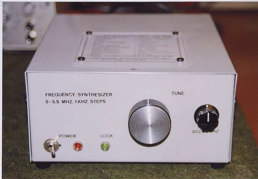
Figura N°5: Vista exterior del sintetizador. Detalle del panel frontal de izquierda a derecha, el interruptor e indicador POWER, indicador LOCK, mando del decodificador óptico rotativo de sintonía y el ajuste de frecuencia o RIT de 2,2 KHz.
