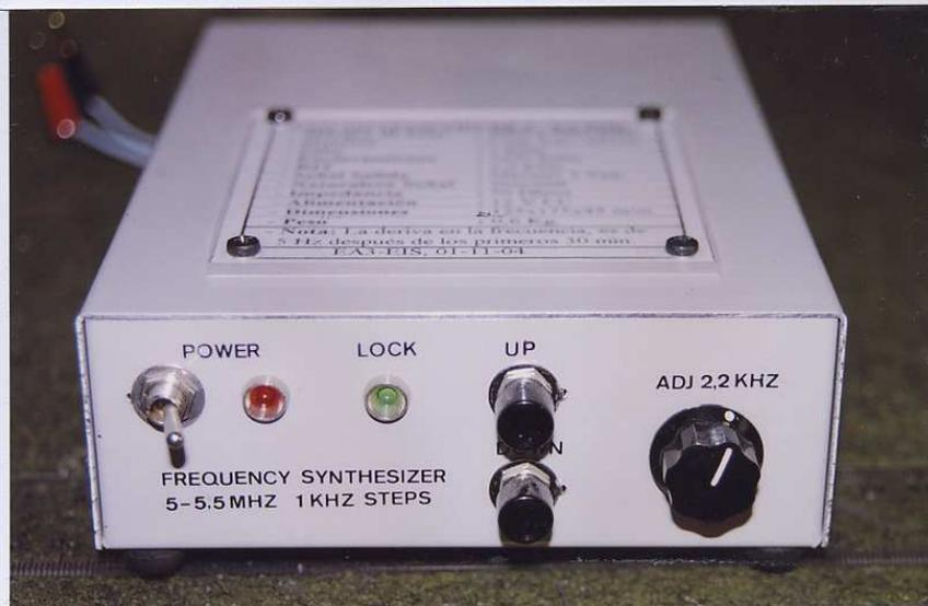
**Figura N°4:** Vista interior del sintetizador. Detalle del panel frontal, de izquierda a derecha, el interruptor e indicador POWER, led indicador LOCK, pulsadores Up – Down de sintonía por saltos de 1 KHz y ajuste de frecuencia o RIT de 2,2 KHz.
