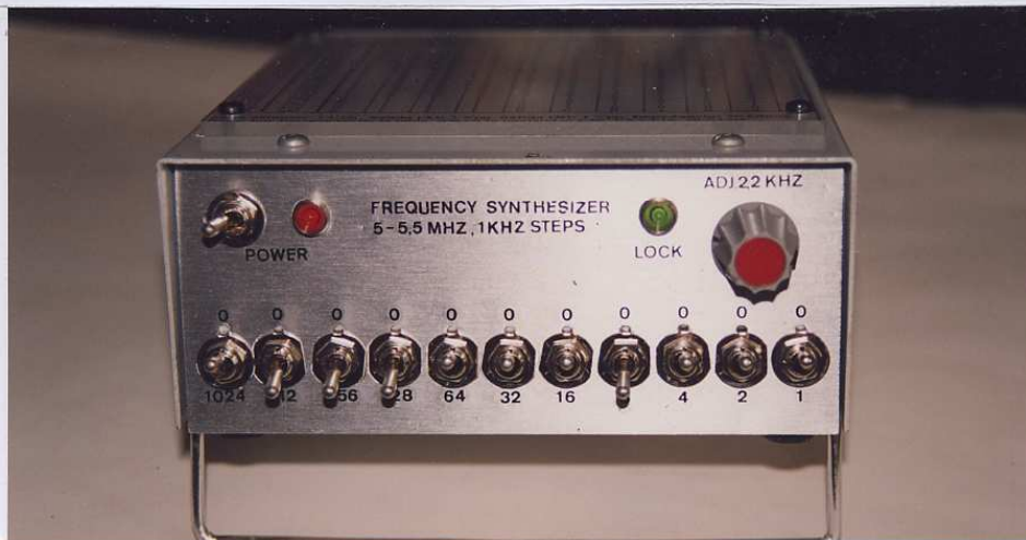
Figura N° 5: Vista exterior del sintetizador. Destacan, el conmutador y led rojo POWER; el led verde LOCK, testimonio de enganche del PLL; el mando de ajuste de frecuencia de 2,2 KHz RIT y debajo, los once conmutadores en línea que permiten programar manualmente, la frecuencia útil de salida de RF. El sistema no es muy operativo, pero como experiencia es recomendable.
