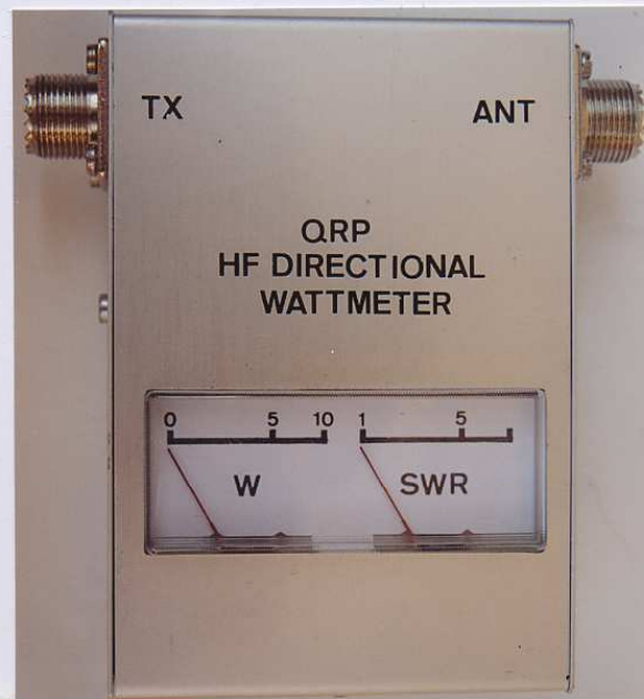
Figura N° 2: Vista exterior, del vatímetro direccional HF QRP. Destacan los dos conectores PL contrapuestos, que permiten sea intercalado dicho vatímetro, en la línea de transmisión. También pueden verse, los dos instrumentos de c/m con sus respectivas escalas W y SWR.
