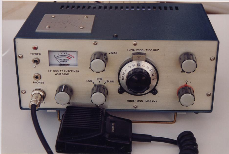
**Figura N° 9(A):** Vista exterior del Transceptor para 40 Metros. Panel frontal de izquierda a derecha tenemos: El mando Power, salida Phones y conector para Micro-PTT, Instrumento de c/m para la presentación de la señal en Rx y Potencia relativa de RF en Tx, mandos de Ganancia Tx y Mode, en el centro el mando de Sintonía con reductor y escala de 0 a 100 KHz., Ganancia Rx, RIT +/- 2 KHz y en la tapa superior, un pequeño altavoz que se selecciona al conectar los auriculares en el Jack
