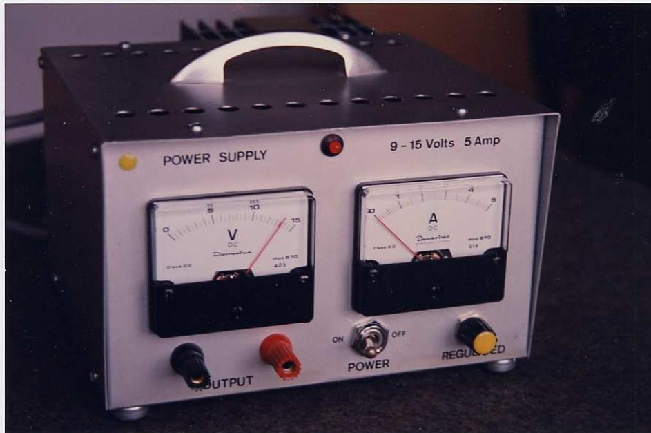
**Fuente de Alimentación Estabilizada Regulable de 9 a 15 Volts - 5 Amp:** Vista exterior. Cabe destacar el Voltímetro de 15 Volts y el Amperímetro de 5 Amp; Bornes de salida (+-); Mando Off-On; Ajuste manual de la tensión de salida; Los fusibles AC de primario, Dc de 5 Amp. y otra salida (+-) se encuentran en la parte posterior de la fuente a un lado del disipador de los transistores de potencia.
