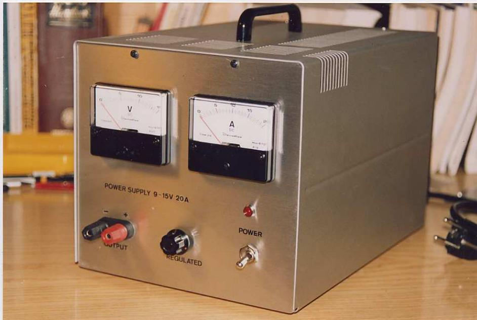
**Fuente de alimentación estabilizada regulable de 9 a 15 Volts – 20 Amps.** Vista exterior, destacan los dos instrumentos de c/m: Voltímetro con escala de 15 Volts y amperímetro escala de 20 Amp; los bornes de salida (+ -), potenciómetro de ajuste de la tensión de salida, mando Power y el correspondiente Led rojo de control.
