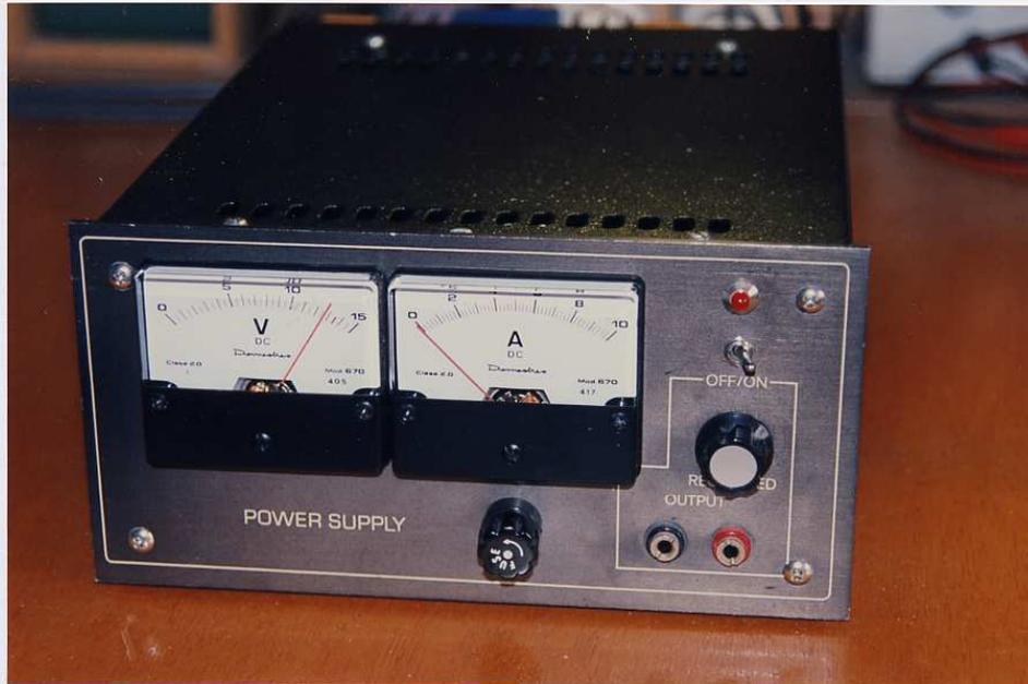
**Fuente de Alimentación Estabilizada Regulable de 9 a 15 Volts - 10 Amp:** Vista exterior. También destacables el Voltímetro de 15 Volts y el Amperímetro de 10 Amp; Bornes de salida (+-); Interruptor general Off-On; Fusible DC de 10 Amp. y mando multivuelta para regular la tensión de salida.
