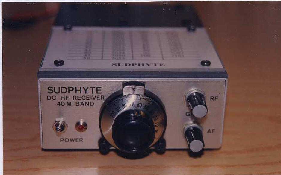
**Figura N°2:** Vista exterior del receptor de conversión directa para la banda de 40 metros Sudphyte. De izquierda a derecha, el interruptor y led Power, el mando y dial de sintonía y finalmente, el atenuador continuo de RF y mando de amplitud AF. En la parte superior de la caja, el altavoz y en primer término, un listado de correspondencia entre el dial y las frecuencias.
