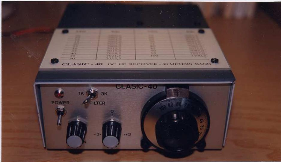
**Figura N°6:** Vista exterior del receptor de conversión directa para 40 metros Classic 40. Por la izquierda, el interruptor y led Power, debajo los mandos: AF Gain y RIT, justo encima el selector de filtros LPF de 3 y 1 KHz y el mando de sintonía con el dial de 0 a 100. En la parte superior de la caja, el altavoz y en primer término, un listado de correspondencia entre el dial y las frecuencias.
