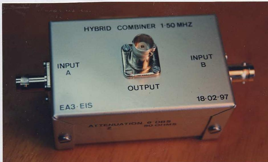
**Figura N°1:** Vista exterior del combinador híbrido el cual, es una parte importante del sistema de evaluación, al permitir aplicar dos señales de RF de manera simultánea sin alterar su morfología y es capaz, de mantener la impedancia de la red atenuadora en 50 Ohms. Véanse los conectores BNC hembra, el transformador separador y las resistencias que configuran el circuito puente de RF.
