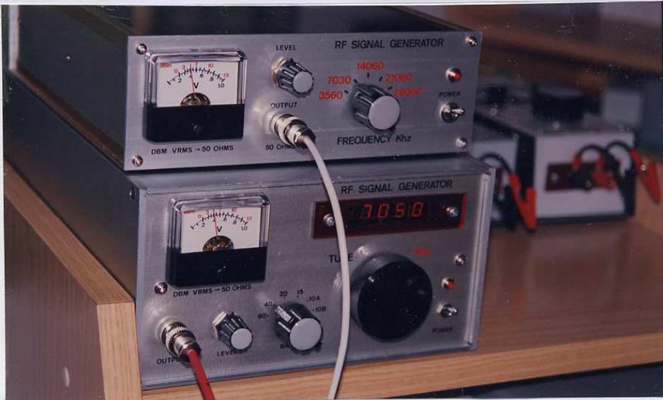
**Figura N°3:** Generadores de RF utilizados en el sistema de evaluación. En la parte inferior, el generador controlado por VFO, frecuencímetro de cinco dígitos con una resolución de 1 KHz y selector de bandas. En la parte superior, el generador de frecuencias fijas controladas por cristal y el correspondiente selector. Ambos generadores, disponen de control de señal Level e instrumento c/m con escalas de dBm y Vrms. Salida de 50 Ohms por conector BNC con carga interior permanente.
