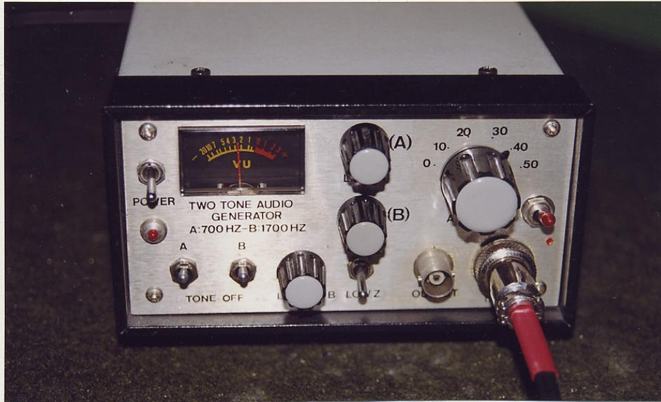
**Figura N°3:**Generador de Doble Tono. Vista exterior de izquierda a derecha: Instrum. c/m Vu Meter; Los dos conmutadores ON-OFF para simultanear o independizar los dos Tonos: "A y B"; Los controles de nivel de señal: "A y B" y simultáneo "A+B"; Selector de impedancias de salida; Atenuador Rotativo de 50 dB; Los conectores de salida y pulsador momentáneo PTT.
