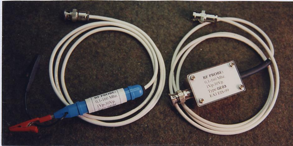
**Figura N° 4 (B):** Una vista avanzada de dos sondas demoduladoras de RF ya operativas, la sonda de la izquierda es del tipo lápiz y la de la derecha es del tipo BNC. El cable que se ha utilizado en ambas, es de vídeo 75 Ohms, con una longitud de algo más de un metro, la conexión con el voltímetro CC de alta impedancia, es mediante conector BNC macho. Posteriormente se dan más detalles, tanto constructivos como también de acabado de los tres tipos de sondas.
