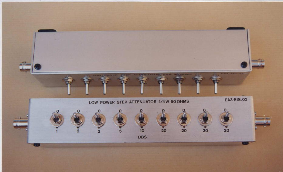
Figura N°5: Vista exterior del Atenuador por Pasos de baja Potencia ya operativo. Aquí se puede apreciar bien, la caja envolvente exterior de Al, la cual permite, además de disponer de un segundo blindaje, el dar un acabado con unas indicaciones de carácter funcional. También están presentes, los dos conectores BNC sujetos con tornillos M2, ambos de entrada y salida de señal.
