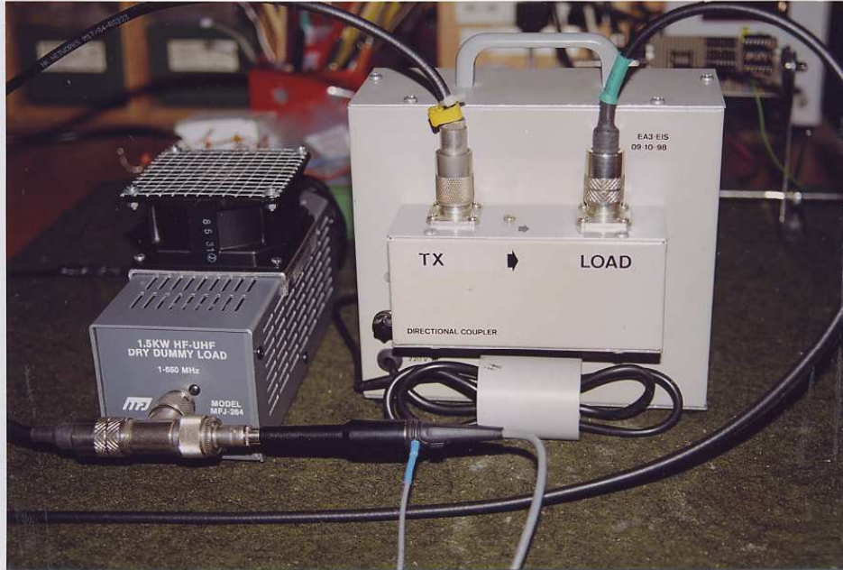
Figura N° 17: Vista exterior posterior del vatímetro con el acoplador direccional adosado a la tapa trasera, de el solo destacan, los dos conectores PL correspondientes a TX – LOAD y el cable de red para su conexión a 220 V el cual, está dispuesto en su recogedor de PVC.
