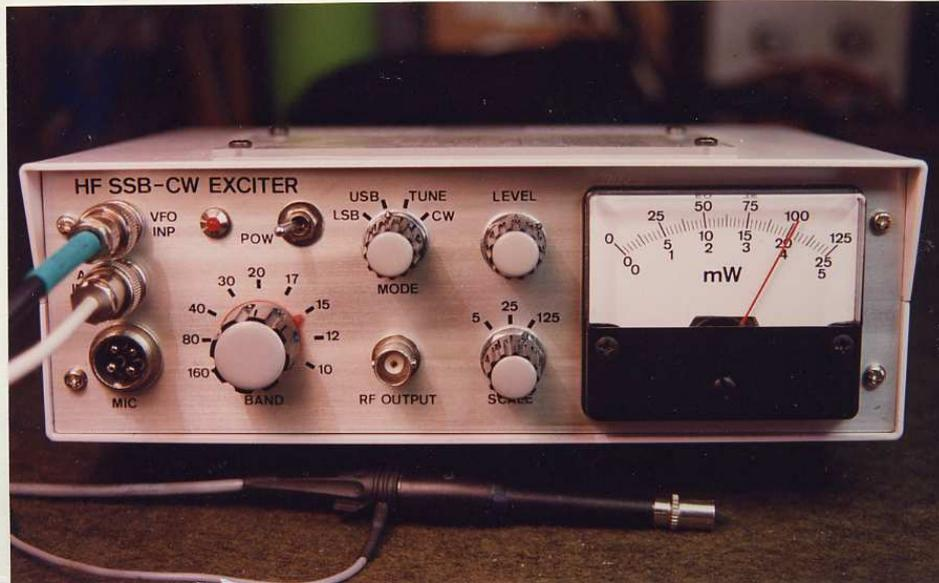
Figura N°13: Excitador HF Multibanda para SSB y CW. Vista exterior Frontal, de izquierda a derecha. Las entradas de señal exterior: VFO, AF y Micro/PTT, interruptor de red, selector de Bandas, selector de Modo, salida de RF, ajuste de nivel Level, selector de Escalas e Instrumento de c/m con sus tres escalas de Potencia en mW y de carácter lineal.
