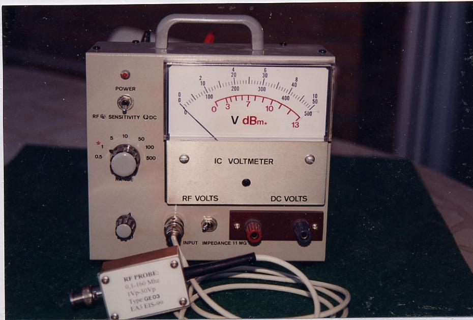
**Figura N°4:** Otra vista exterior del Voltímetro analógico para CC y RF de alta impedancia. Aquí aparece complementado con el tipo de sonda BNC en caja hermética, de mayores prestaciones en cuanto a rango de frecuencia. La escala de 0 a +13 dBm, se corresponde con la escala de 1 Vrms.
