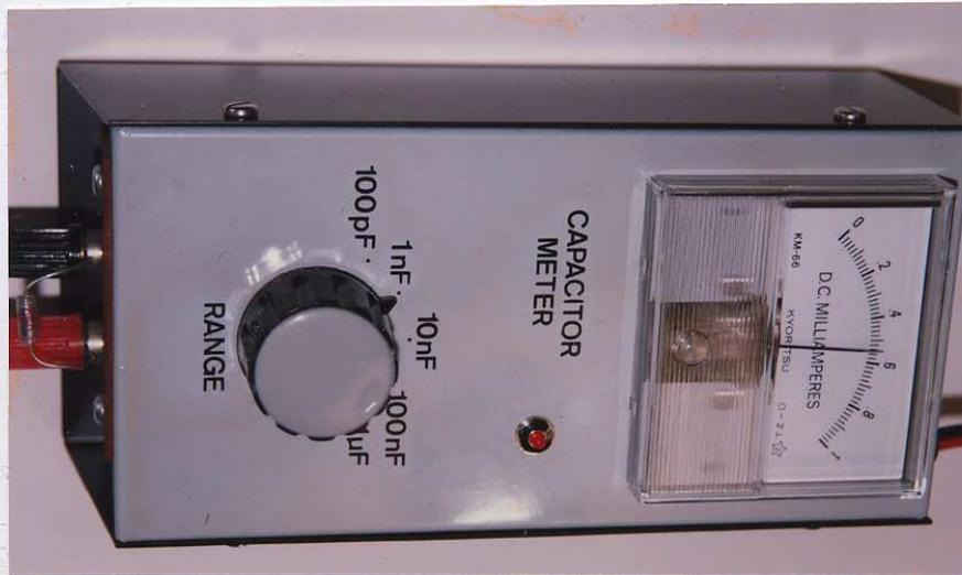
**Figura N°3:** Vista exterior del capacitmetro. De izquierda a derecha los bornes del condensador bajo prueba, el selector Range con cinco márgenes de medición y el instrumento de c/m con una única escala de 0 a 1 mA.
