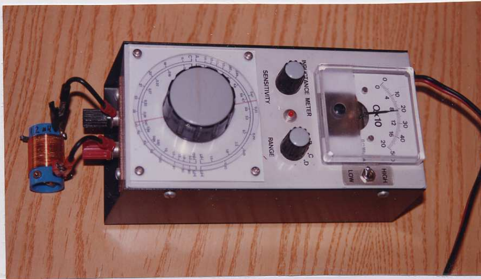
Figura N°2: Medidor de inductancia y Q relativo, vista exterior de izquierda a derecha. Los bornes L, el mando y la escala del condensador variable C, el selector de escalas Range, el control de amplitud Sensitivity y el instrumento de c/m indicador de Q con el selector High-Low.
