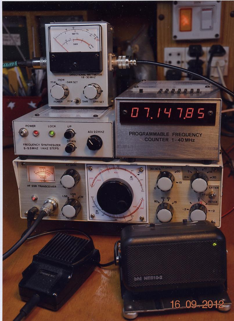
**Transceptor Multibanda HF, 80, 40, 20 y 15 metros, modos SSB y CW (15 W).**
